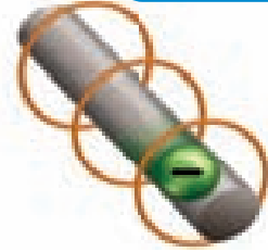
ينتج التيار الكهربائي (الإلكترونات المتحركة) المار في سلك فلزي مستقيم مجالاً مغناطيسياً
