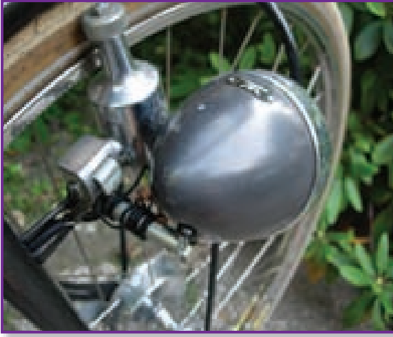
يتصل المولد الكهربائي بعجلة الدراجة
